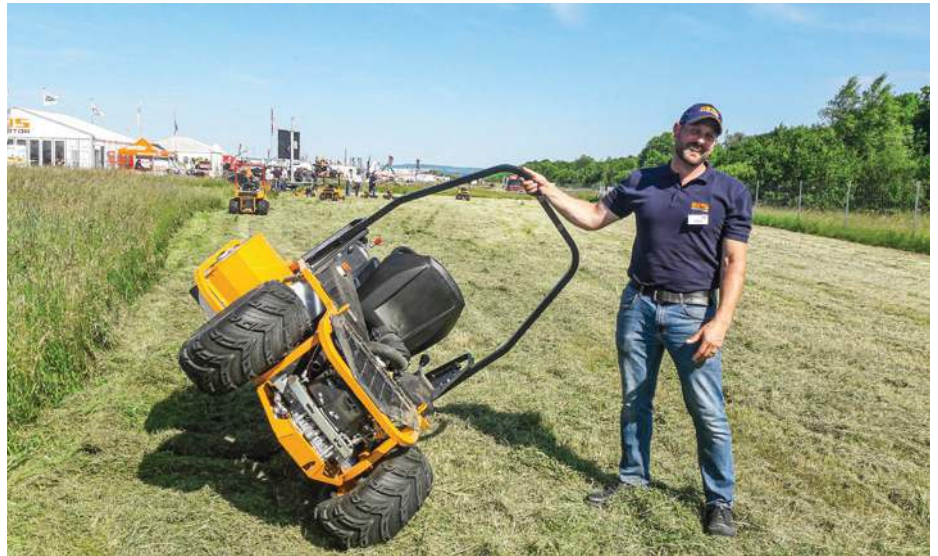
Georg-Otto Fuchs, Vermarktungsleiter bei AS-Motor, zeigte in Eisenach den Schlegelmäher AS 1040 YAK 4WD, der 2018 auf den Markt kam. Er zerkleinert im steilen Gelände Aufwuchs bis zu 1,50 m. Wesentlich für die Geländegängigkeit ist der niedrige Schwerpunkt und die optimale Gewichtsbalance.
